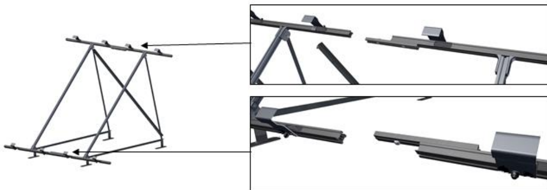
Łączenie kształtowników poprzecznych za pomocą łączników prostych.
