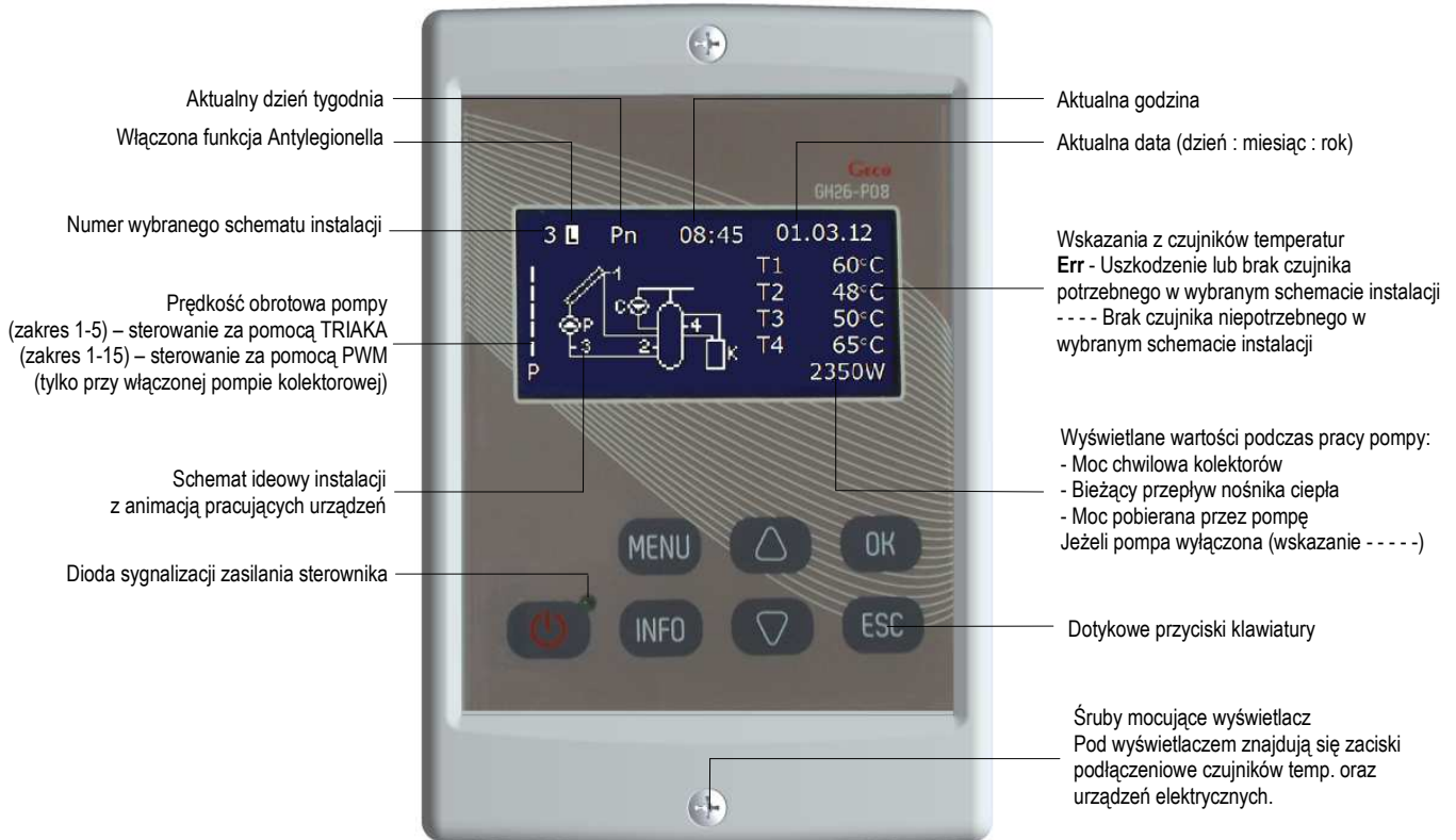
Rys. 2. Opis podstawowego ekranu na wyświetlaczu LCD
