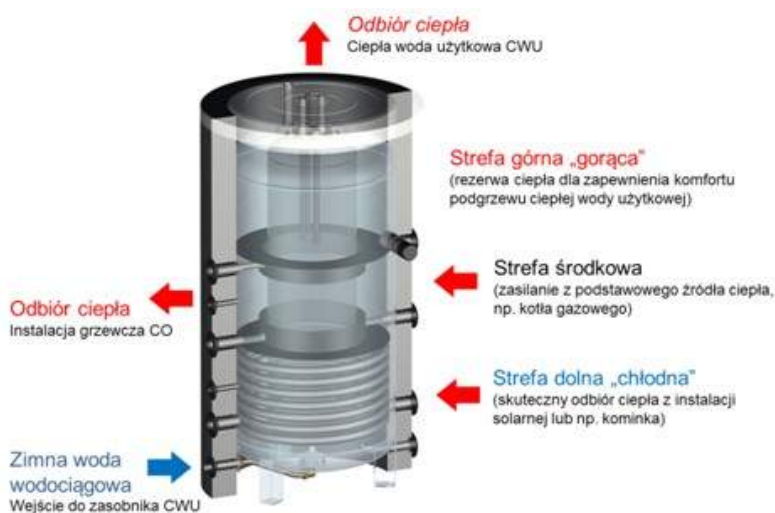
Rysunek 3. Przekrój podgrzewacza uniwersalnego Hewalex INTEGRA oraz sposób funkcjonowania stref temperaturowych.
