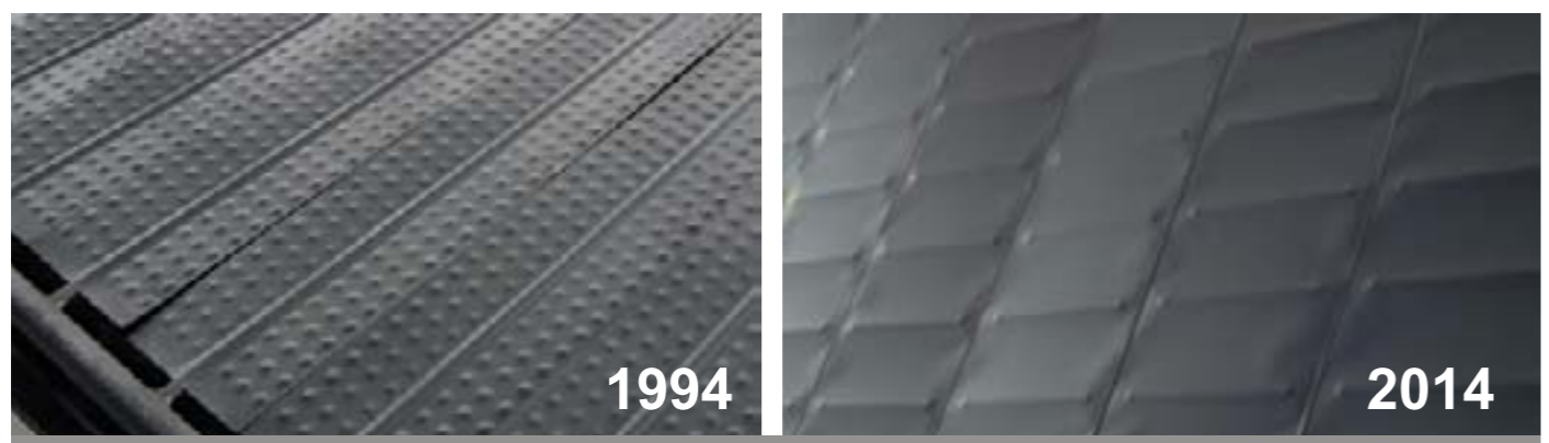
4 Absorber z pokryciem z czarnego chromu – kolektor z 1994 roku (zdjęcie 2014) oraz współczesny 2014 [1]. Sprawność „starego” kolektora według danych z badań certyfikujących jest niższa o około 12% (w zakresie 0÷50 K) od współczesnego, przede wszystkim ze względu na właściwości szyby
