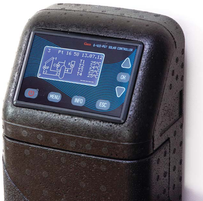
Rys. 1. Sterownik G422 firmy Hewalex umożliwia obsługę podstawowych i złożonych instalacji solarnych dzięki standardowemu wyposażeniu w cztery czujniki temperatury oraz współpracy z elektronicznym przepływomierzem i czujnikiem minimalnego ciśnienia
