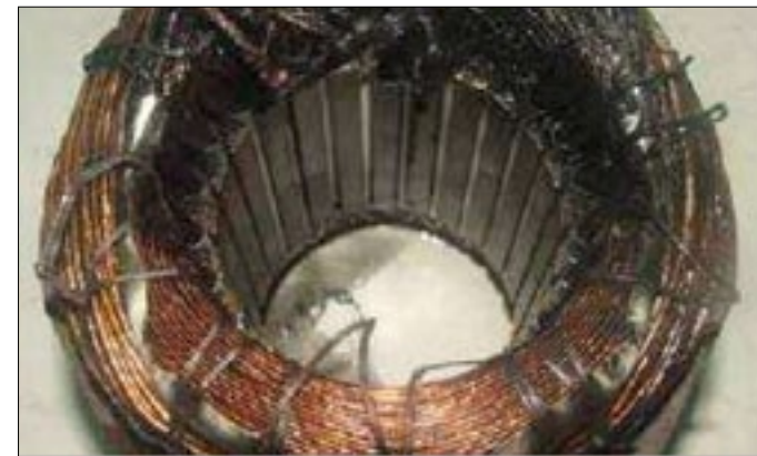
3 Spalone uzwojenie sprężarki
