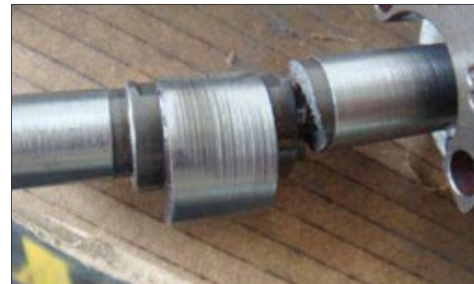
4 Złamanie zmęczeniowe tłoka sprężarki
