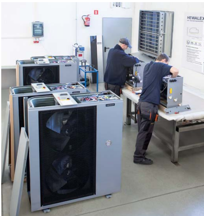
Rys. 3. Montaż pomp ciepła PCCO Split
