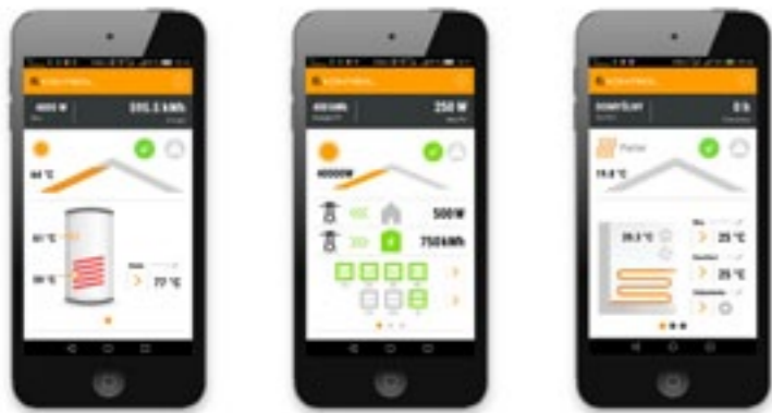
Widok ogólny aplikacji EKONTROL dla zdalnego nadzoru pracy instalacji solarnej, fotowoltaicznej oraz pompy ciepła do ogrzewania, chłodzenia budynku i podgrzewania ciepłej wody użytkowej
