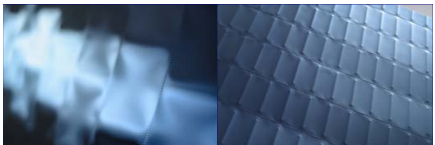
8 Selektywne pokrycia absorberów: typu PVD (z lewej) oraz na bazie czarnego chromu (z prawej) [2]
