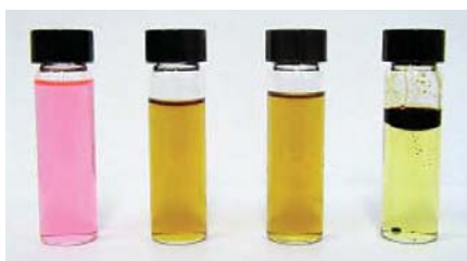
Rys. 2. Badanie glikolu Tyfocor L w temperaturze 235°C, od lewej strony próbka nowego glikolu, po 336 h, po 672 h i po 1008 h (fot. Tyforop Chemie GmbH) [1]
