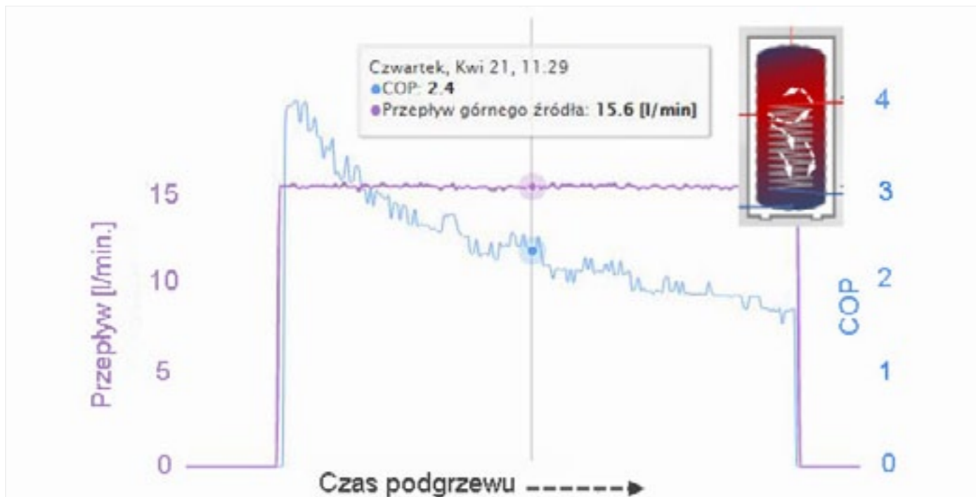
5 Zmiana efektywności COP w trakcie podgrzewania wody w standardowym schemacie podłączenia pompy ciepła [3]
