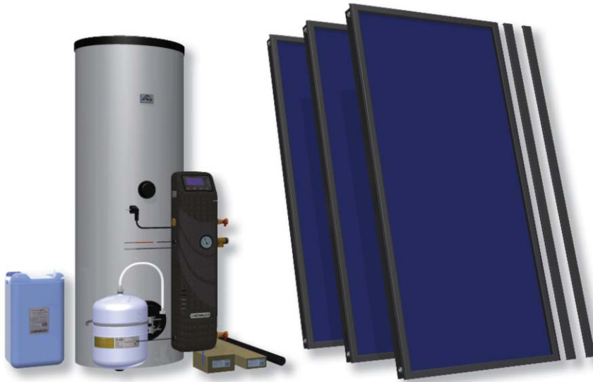
Rys. 2. Nawet typowa mała instalacja solarna przeznaczona do podgrzewania wody użytkowej cechuje się najwyższą w porównaniu do innych źródeł ciepła efektywnością energetyczną. Przykładowo instalacja złożona z trzech kolektorów płaskich Hewalex KS2100 TLP AC w miesiącach letnich może dostarczać około 300-350 kWh ciepła (symulacja GetSolar), zużywając około 7 kWh energii elektrycznej. Efektywność COP liczona jak dla pompy ciepła wyniosłaby około 50
