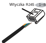
Rysunek 4.36 Usuń warstwę izolacji i podłącz do wtyczki RJ45
