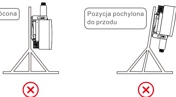
Rysunek 3.10 Niewłaściwy kąt montażu
