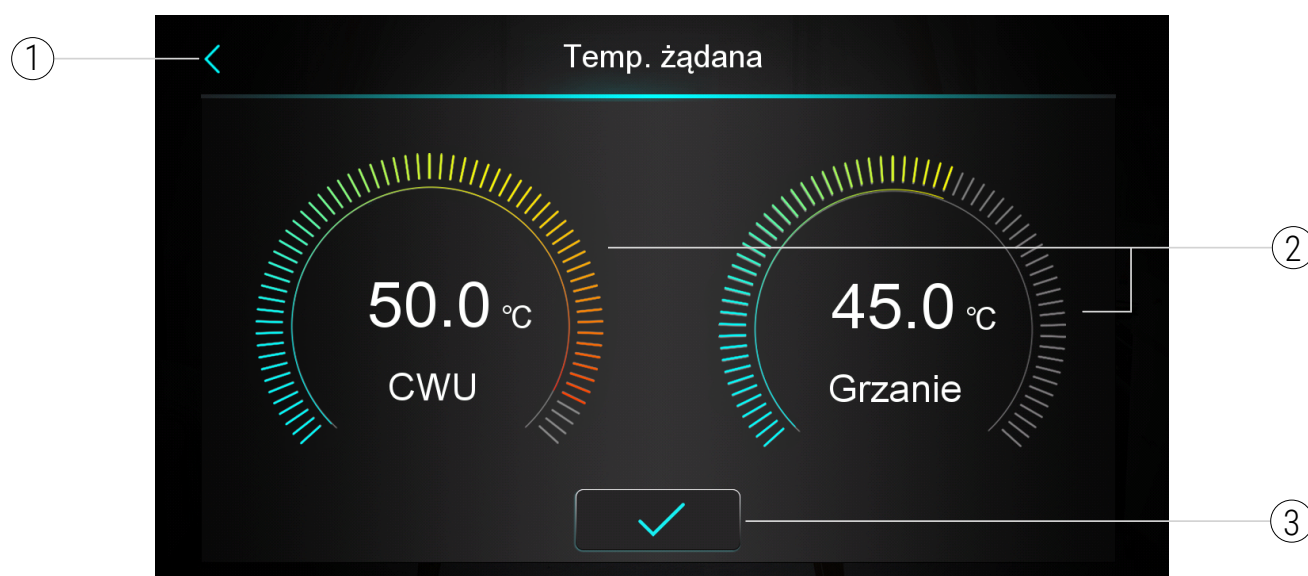
Rys. 5 Ustawienia temperatury żądanej - sterowanie obiegami grzewczymi wyłączone.
