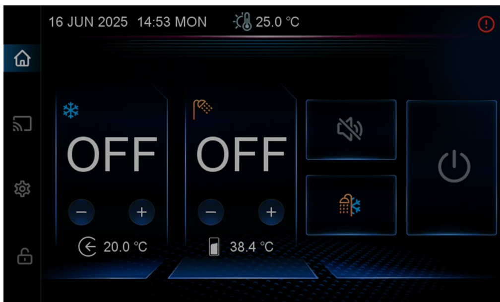
Rys. 6 Ekran sterownika przy wyłączonej pompie ciepła i wyborze trybu pracy Cooling+DHW lub Heating+DHW
