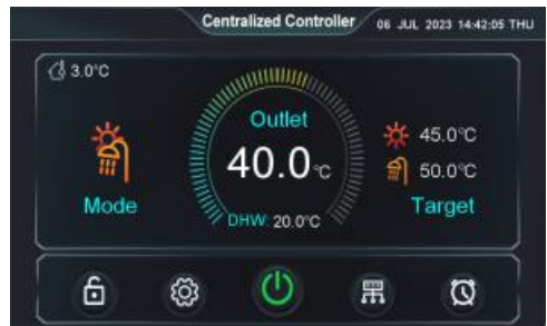
Rys. 9. Ekran sterownika przy włączonej pompie ciepła i wyborze trybu pracy Heating+DHW.
