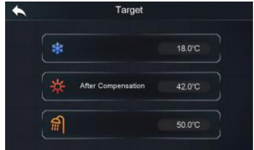
Rys. 11. Sygnalizacja pracy projektu wg krzywej grzewczej.
